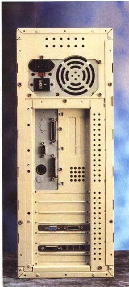
Particolare del retro: notare i numerosi fori di aerazione.
